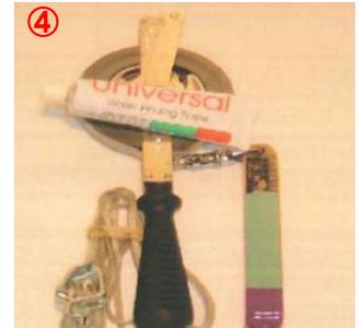
④ ゲージの棒を燃料タンクから引き抜くと、ペーストの変色位置より、容易に水分の存在位置を特定できる
